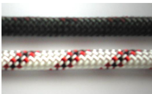
Abb.3: Schwarzfärbung des Seiles durch Bremsstaub
