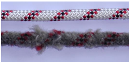
Abb.2: starker Seilabrieb, Abnutzung mit Seilverdickung
